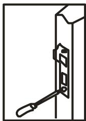
10. Potriviti placuta pe tocul usii in dreptul marcajelor si dati gauri cu un burghiu  $\varnothing$ 12mm. Finisati gaurile si fixati definitiv placuta in holzsuruburi.
