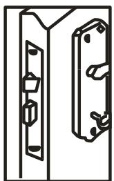
9. Montati definitiv sildurile, clantele si butucul. Inchideti usa si cu un creion marcati, pe tocul usii pozitia zavoarelor de inchidere.
