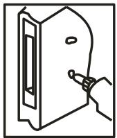
7. Folositi un burghiu  $\varnothing$ 19mm pentru gaura clantei si pentru gaura cilindrului butuc, burghiele  $\varnothing$ 12mm si  $\varnothing$ 19mm. Uniti si ajustati gaurile pentru butuc cu o dalta.
