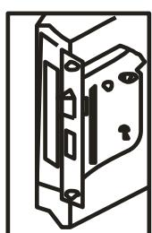
6. Fixati broasca paralel cu cantul usii, in linie cu marcajul si marcati gaurile pentru cheie clanta si silduri.
