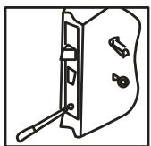
8. Plasati broasca in fanta decupata si introduceti clanta si cilindrul butuc in broasca. Apoi fixati broasca in holzsuruburi si fixati cilindrul butuc in broasca cu surubul M5x45.
