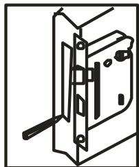
1. Folositi corpul broastei drept sablon, pentru a marca pe cantul usii, pozitia gaurilor. Folositi echerul, ruleta si creionul pentru a efectua un trasaj cat mai precis si corect
